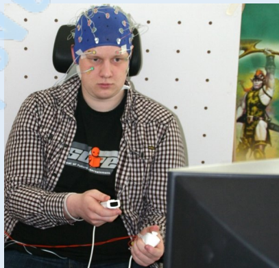
ภาพที่ 1.7 ภาพตัวอย่างการวัด คลื่นไฟฟ้าสมอง (EEG) ระหว่างเล่นวิดีโอเกม ที่มา: Nacke, 2009
